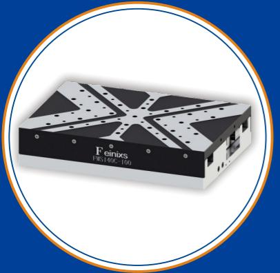
菲克科技开发的长行程高精度交叉滚柱位移台，弥补了长行程直线导轨和短行程交叉滚柱导轨位移台之间的行程空缺，可达亚微米级的重复定位精度。采用德国一体化集成式交叉滚柱导轨、运行精度G1级，确保直线度和体积更小巧，同时匹配进口无铁芯直线电机保证移动速度的均匀性，可适配FMC04全系列控制器，简单易用。
