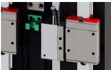
标配0.05μm分辨率光栅尺 全闭环控制
