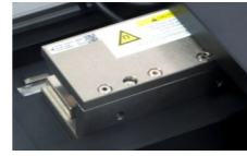
进口无铁芯直线电机 运行更平顺
