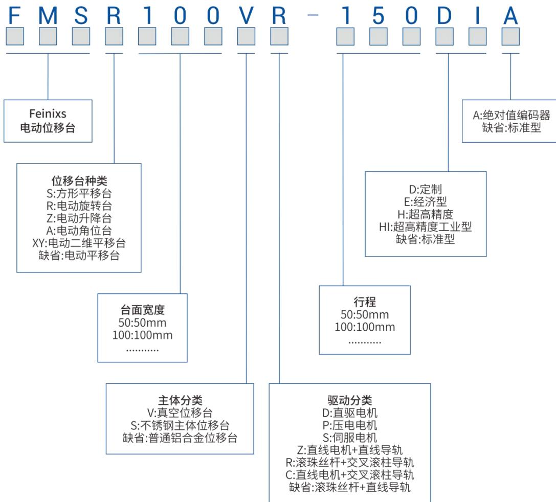
例: FMS225Z-200HI 表示: 平移台+台面宽度 225mm+直线电机+直线导轨+行程 200mm+超高精度工业型。
