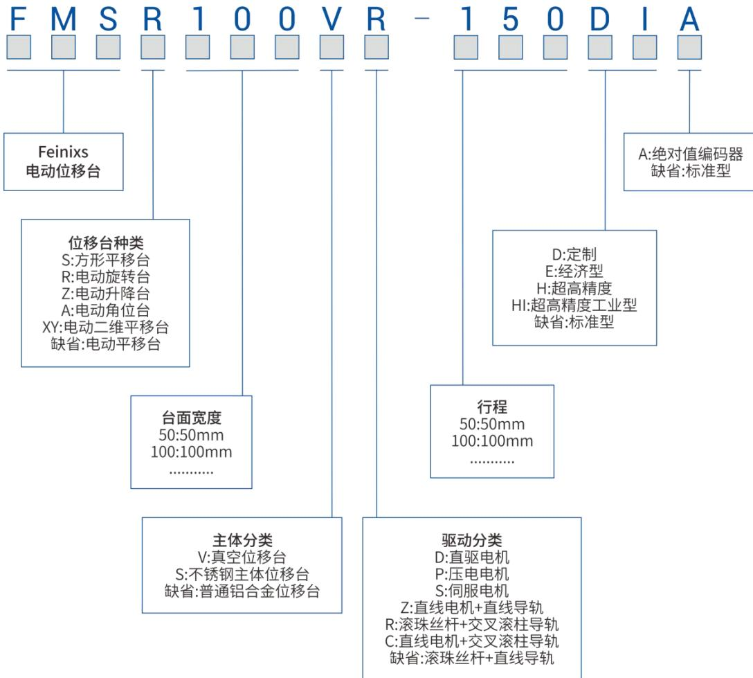
例：FMSS90C-38 表示：方形平移台+台面宽度 90mm+直线电机+交叉滚柱导轨+行程 38mm。
