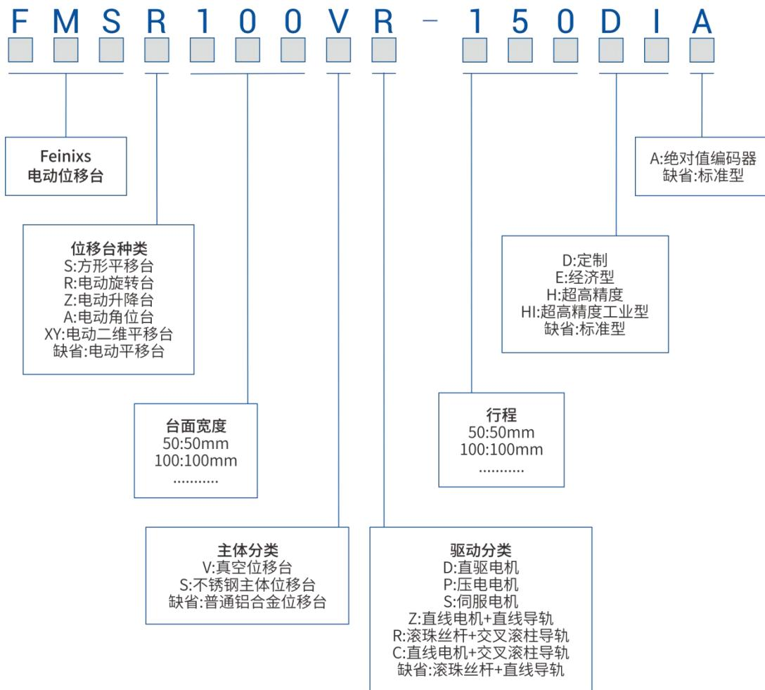
例: FMS115R-50 表示: 电动平移台+台面宽度 115mm+滚珠丝杆+交叉滚柱导轨+行程 50mm。
