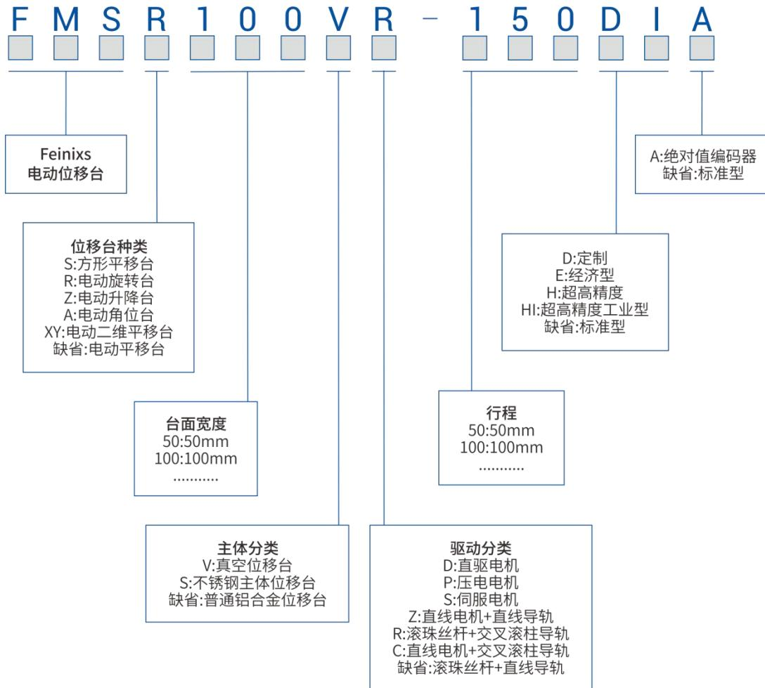
例：FMS80R-50 表示：电动平移台+台面宽度 80mm+滚珠丝杆+交叉滚柱导轨+行程 50mm。
