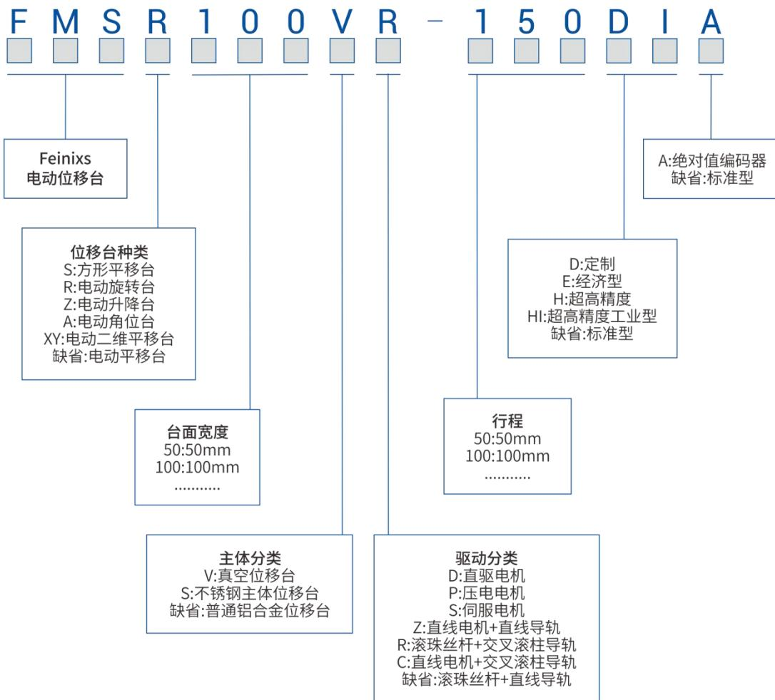
例: FMSZ140C-100 表示: 电动升降台+台面宽度 140mm+直线电机+交叉滚柱导轨+行程 100mm。
