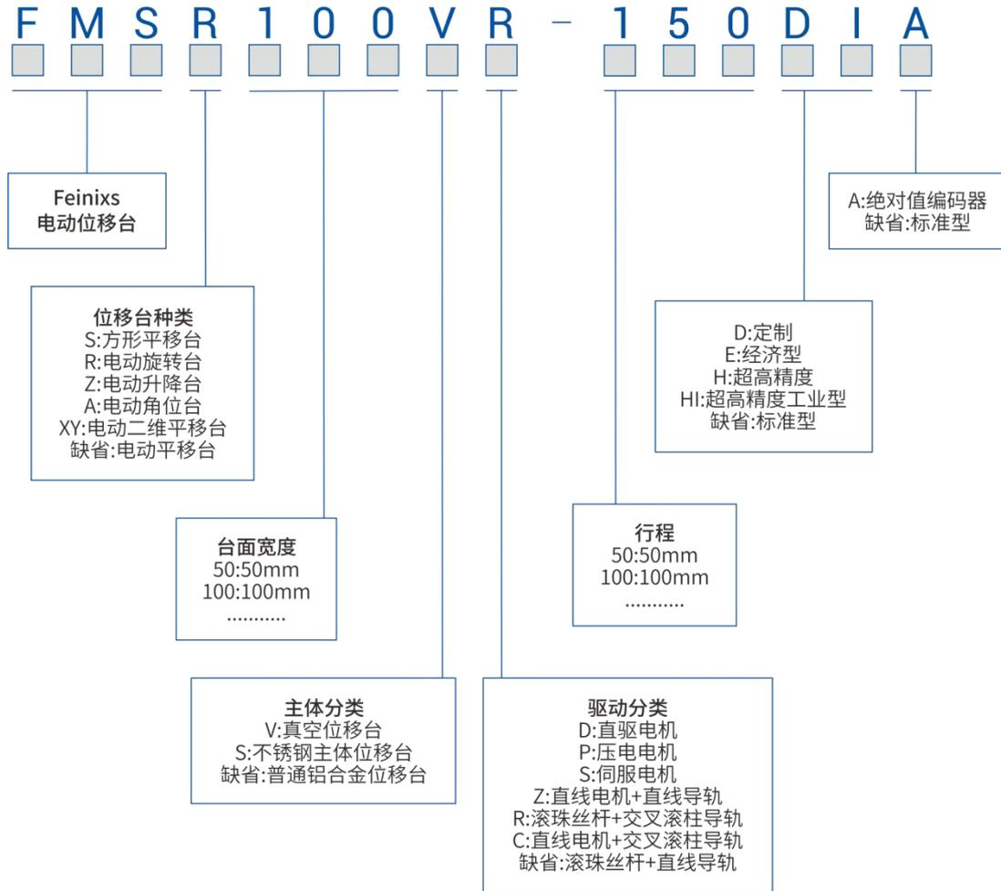
例：FMSZ65C-08 表示：电动升降台+台面宽度 65mm+直线电机+交叉滚柱导轨+行程 8mm。
