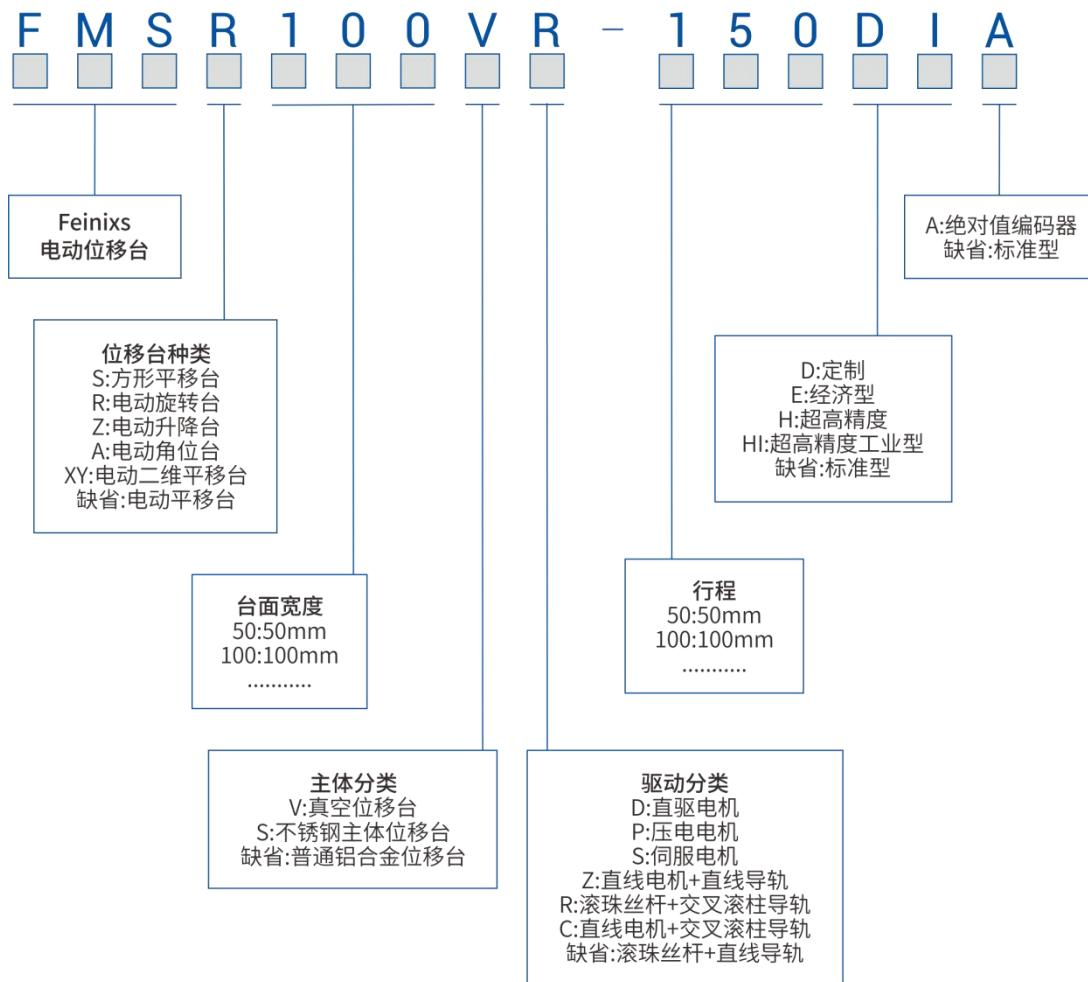
例：FMSZ85R-20 表示：电动升降台+台面宽度 85mm+滚珠丝杆+交叉滚柱导轨+行程 20mm。
