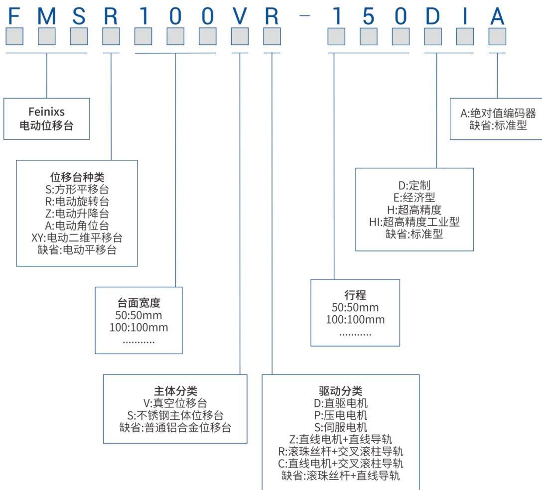
例：FMSZ115R-50 表示：电动升降台+台面宽度 115mm+滚珠丝杆+交叉滚柱导轨+行程 50mm。
