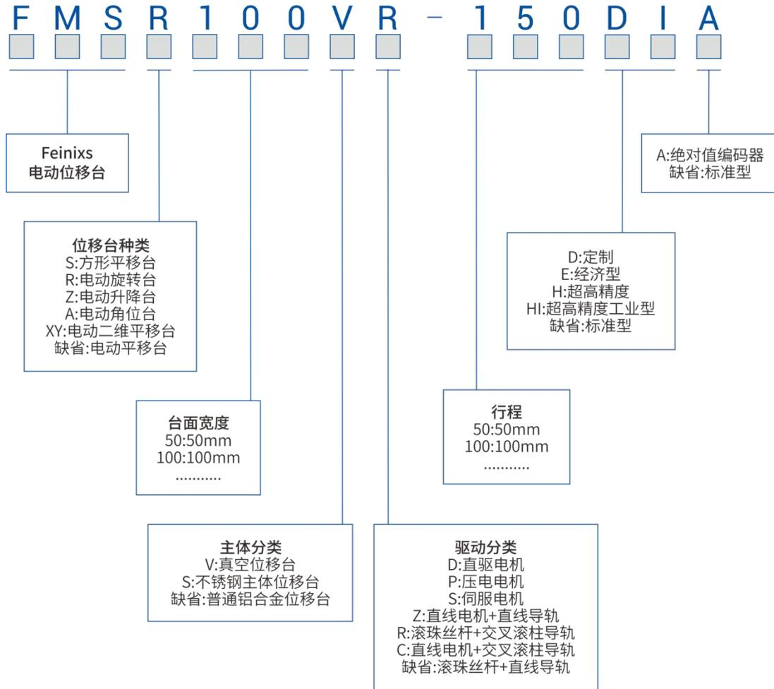
例：FMS120V-100 表示：电动平移台+台面宽度 120mm+真空位移台+滚珠丝杆+直线导轨+行程 100mm。
