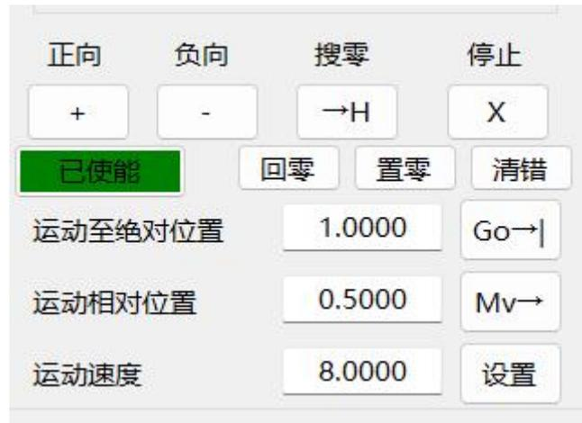
运动控制主要包括以下几种方式：搜零、点动、相对运动、绝对运动。
