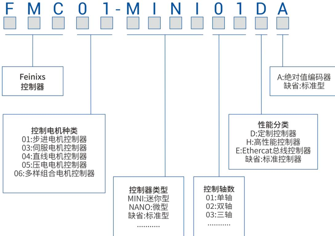
例：FMC01-04HCL 表示：步进控制器+4 轴+高性能控制器+闭环控制
