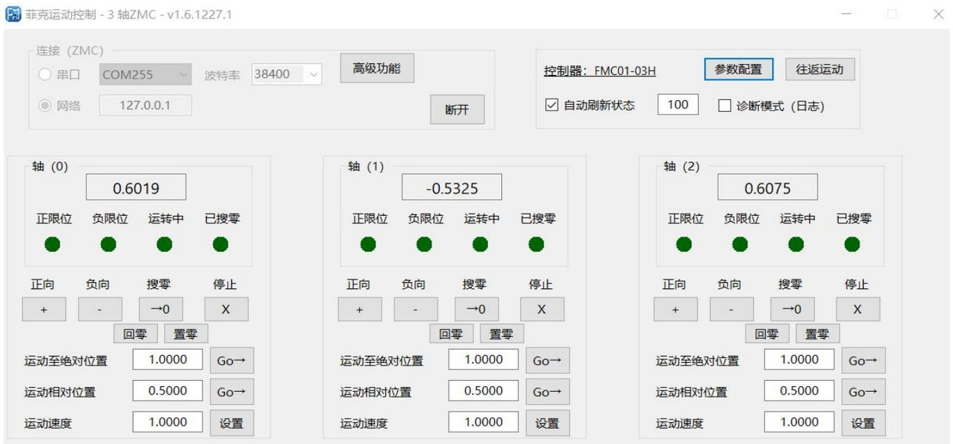
运行软件时先选择对应的控制器型号，如图所示，选择“FMC01-03H”，点击“确认”，界面跳转到软件主界面如上图所示。
